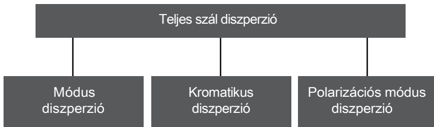
19. ábra A szál diszperzió típusai
