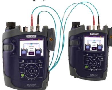
30. ábra Optikai veszteségmérők (OLTS)
