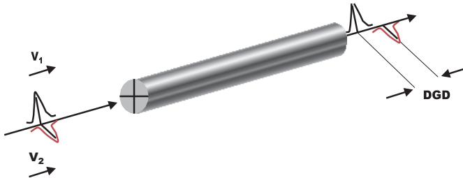
22. ábra Polarizációs módus diszperzió (vagy differenciális csoportkésés)
